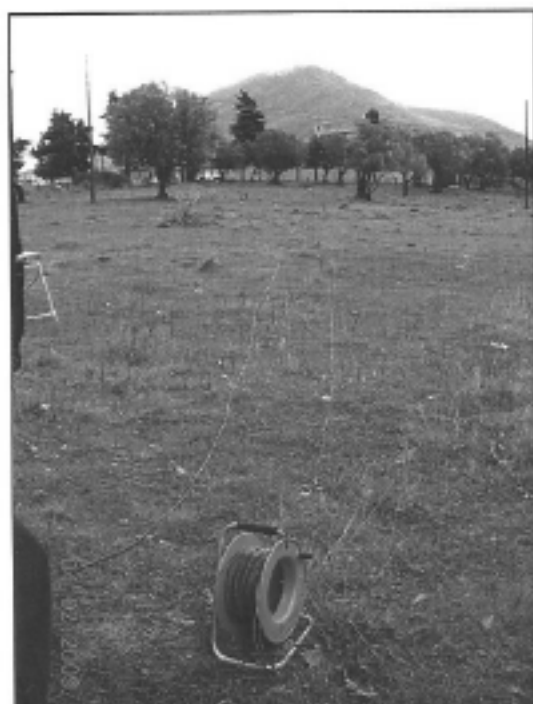
Foto n. 1 Stendimento sismico a rifrazione SS1
